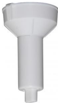
Рисунок 1 — Магнітна воронка з магнітною індукцією 40 \pm 10 мТл
