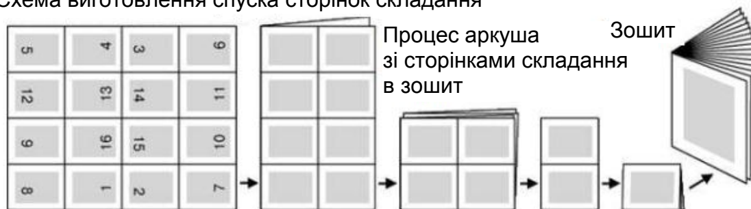
Рис. 4.5. Схема побудови електронного макета спуска
