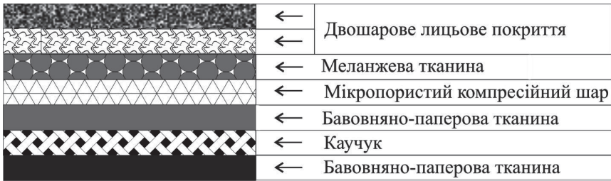
Мал. 7.1. Структура офсетного полотна з компресійним шаром
