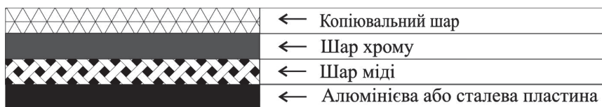
Мал. 4.4. Структура біметалевої пластини
