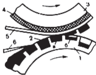
Мал. 5.2. Схема отримання відбитка у глибокому (прямому) способі друку: 1 – форма; 2 – шар друкарської фарби; 3 – друкарський циліндр або тигель; 4 – декель; 5 – папір; 6 – ракець
