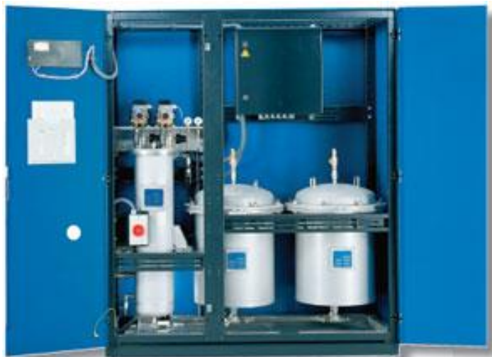
Рис.2.5. Система управління і регенерації розчинників Technotrans есо очищає забруднені розчини для повторного використання в друкарській машині, дозволяючи економити на утилізації
