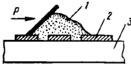
Рис. 13.3. Нанесення пасти на підкладку: 1 – паста; 2 – трафарет; 3 – підкладка
