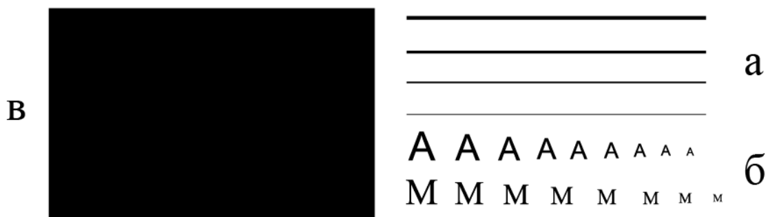
Рис. 12. Тест-форма: а — штрихові елементи; б — текстові контрольні поля; в — плашкове поле
