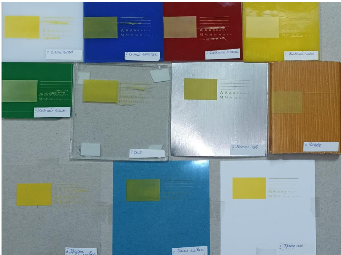
б — нанесення двох шарів фарби (друк в «два удари»)
