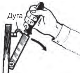
Рис. 3.7. Приклад виникнення самоіндукції (дуги)
