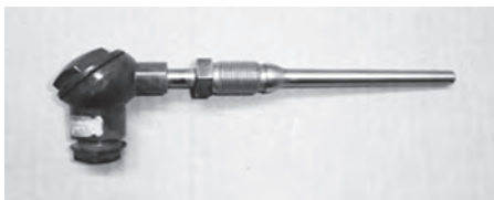
Рис. 4.8. Загальний вигляд ТЕП
