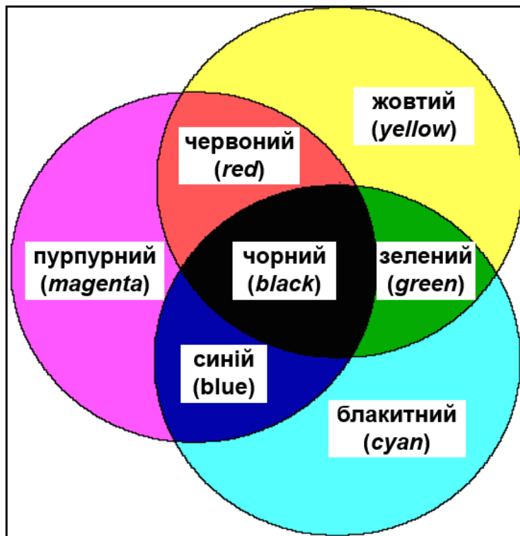
Рис. 3.2. Субтрактивний синтез кольору із застосуванням трьох основних фарб: блакитної, пурпурної та жовтої
