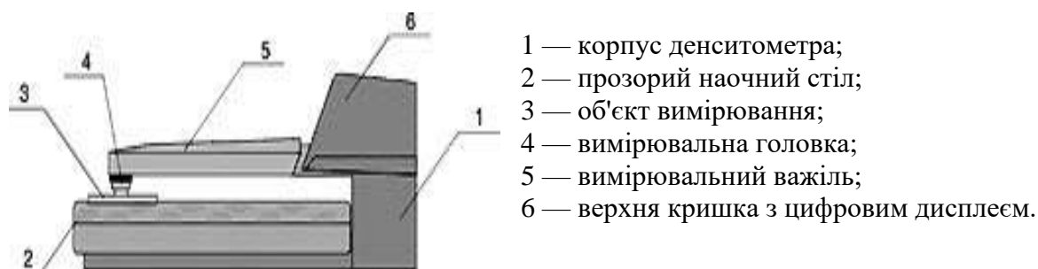
Рис. 2. Загальний вигляд однієї з конструкцій денситометра.
